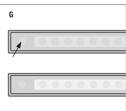
Tras conectar el aparato, el interruptor hará un autotest de circa 20 segundos para el ajuste. El encendido y el apagamiento del aparato ocurre a través de un toque rápido del interruptor sensible; un toque más duradero ajusta la intensidad de la luz aumentándola o reduciéndola.
